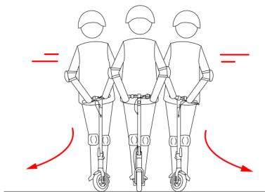
**ЗАПРЕЩАЕТСЯ** резко поворачивать ручку при движении на высокой скорости.
