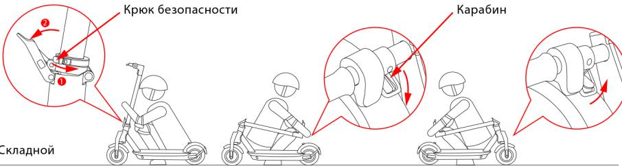
Выключите свой самокат. Поверните предохранительный крюк против часовой стрелки и откройте рычаг быстрой разблокировки.
