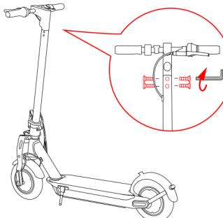
2. Плотно соедините провода внутри ручки и штока. Наденьте ручку на шток. Помните о правильной ориентации.
